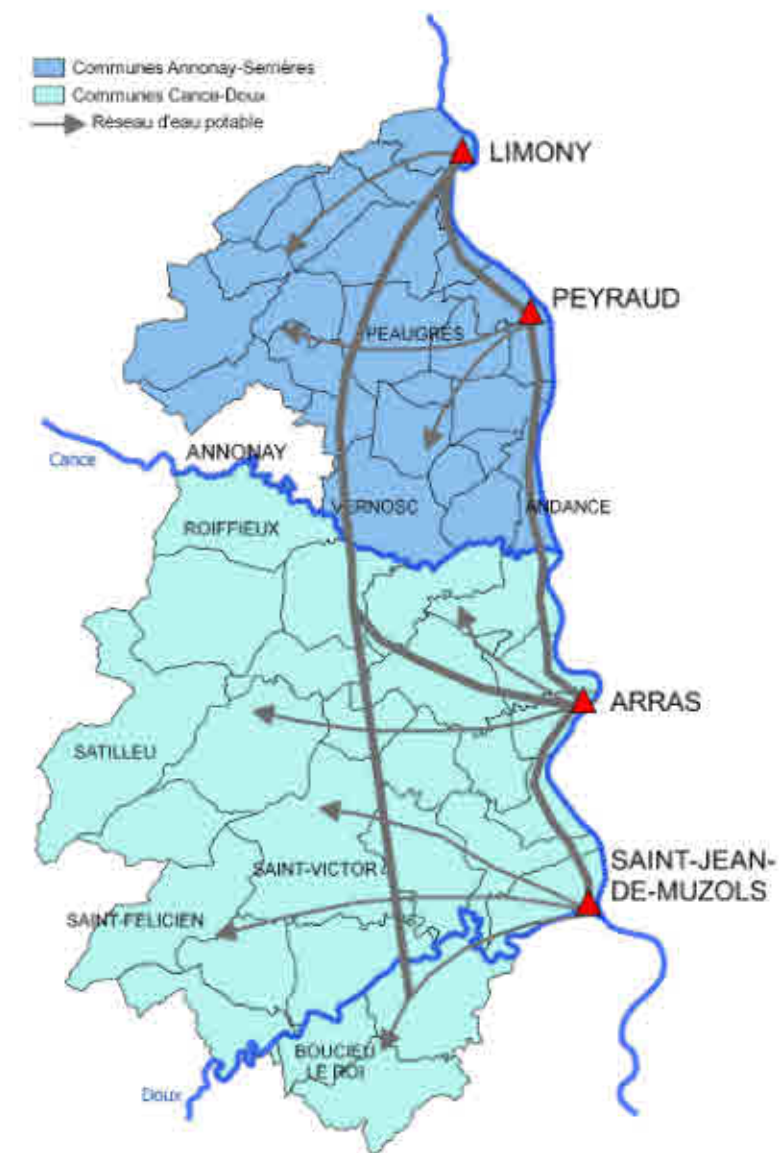
RESEAU INTERCONNECTÉ : SÉCURISATION DES APPROVISIONNEMENTS EN EAU
